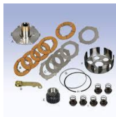
Fig.2 Parts of Piaggio Ape Clutch
